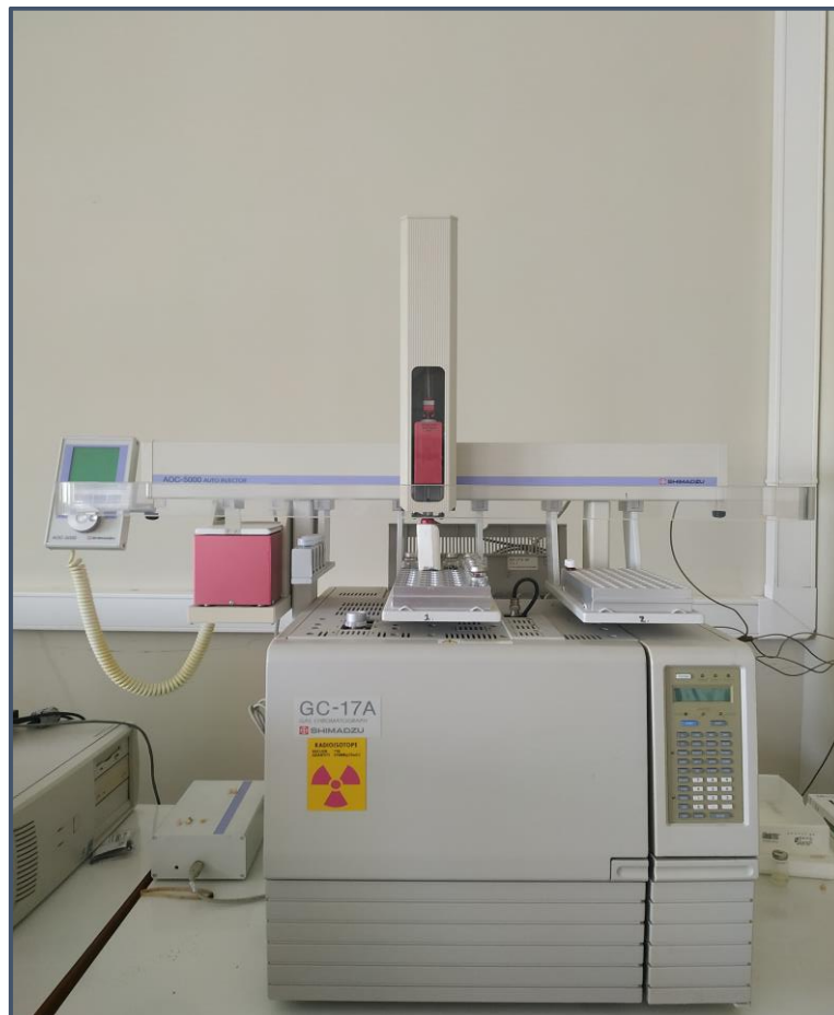
Εικόνα 6. Ο Αέριος Χρωματογράφος, με Ανιχνευτή Ιονισμού Φλόγας και το Headspace, του εργαστηρίου μας
