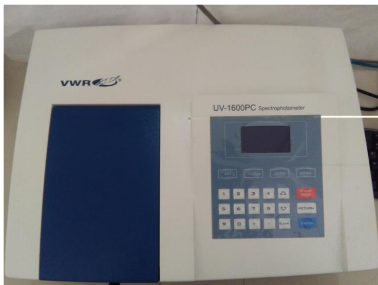
Εικόνα 8 : Το φασματοφωτόμετρο UV-vis που διαθέτει το εργαστήριο
