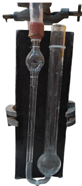
Εικόνα 22. Γυάλινο τριχοειδές ιξωδόμετρο τύπου Ostwald.
