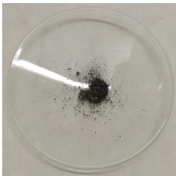
Εικόνα 19. Σκόνη νανοσωματιδίων αργύρου AgNPs
