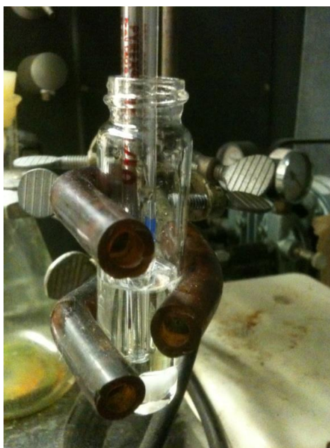
Εικόνα 21. Παροχή αέριου αζώτου N 2 για απομάκρυνση οξυγόνου από το διάλυμα
