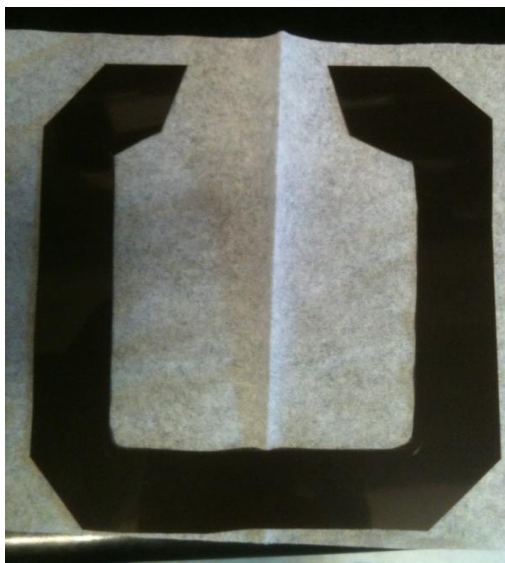
Εικόνα 22. Διαχωριστική μεμβράνη που τοποθετείται μεταξύ των πλακών
