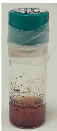
Εικόνα 75: Θολό ανοιχτό πορφυρό διάλυμα παρουσία ιζημάτων Fmoc-Lys(palmitoyl)-NH-TPP c=2\text{mg/ml} σε THF:H 2 O 2:8
