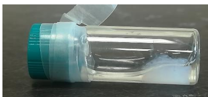
Εικόνα 40: Χαλαρή υδρογέλη του Fmoc-Lys(palmitoyl)-OH c=0,5\text{mg/ml} σε EtOH: \text{H}_2\text{O} 2:8
