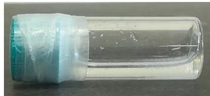
Εικόνα 30: Fmoc-8-aminooctanoic acid c=1\text{mg/ml} σε Ethanol (C 2 H 5 OH): H 2 O 2:8 όπου είναι διακριτά τα λευκά συσσωματώματα που έχουν σχηματιστεί
