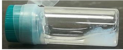
Εικόνα 34: Χαλαρή υδρογέλη του Fmoc-Lys(palmitoyl)-OH c=1\text{mg/ml} σε HFIP:H 2 O 2:8
