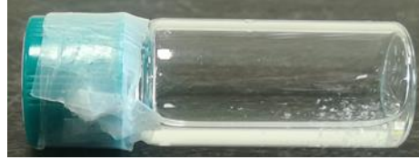
Εικόνα 28: Fmoc-8-aminooctanoic acid c=0.5\text{mg/ml} σε Ethanol ( \text{C}_2\text{H}_5\text{OH} ): \text{H}_2\text{O} 2:8 όπου είναι διακριτά τα λευκά συσσωματώματα που έχουν σχηματιστεί
