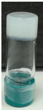
Εικόνα 47: Σταθερή υδρογέλη του Fmoc-Lys(palmitoyl)-OH c=2mg/ml σε EtOH:H 2 O 2:8
