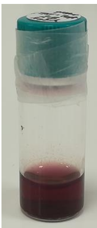
Εικόνα 71: Διαυγές σκούρο πορφυρό διάλυμα παρουσία ιζημάτων Fmoc-Lys(palmitoyl)-NH-TPP c=2\text{mg/ml} σε THF:C 7 H 16 2:8
