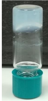
Εικόνα 65: Σταθερή υδρογέλη του Fmoc-Lys(palmitoyl)-OH c=5\text{mg/ml} σε THF:H 2 O 2:8
