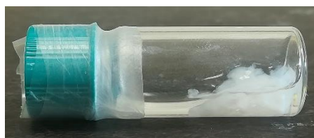
Εικόνα 36: Χαλαρή υδρογέλη του Fmoc-Lys(palmitoyl)-OH c=3\text{mg/ml} σε HFIP: \text{H}_2\text{O} 2:8
