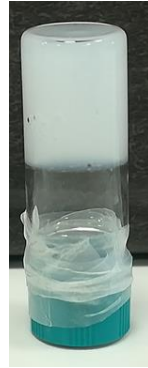
Εικόνα 49: Σταθερή υδρογέλη του Fmoc-Lys(palmitoyl)-OH c=2\text{mg/ml} σε EtOH:H 2 O 1:9
