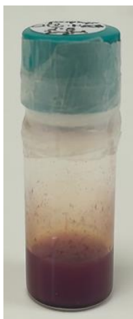
Εικόνα 67: Θολό σκούρο πορφυρό διάλυμα Fmoc-Lys(palmitoyl)-NH-TPP c=2mg/ml σε CHCl 2 :MeOH 2:8
