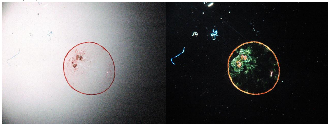
Εικόνα 84: Εικόνες του Fmoc-Lys(palmitoyl)-OH c=1\text{mg/ml} σε EtOH:H 2 O σε οπτικό μικροσκόπιο και κάτω από διασταυρωμένο πολωτή
