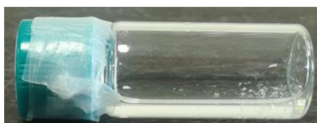
Εικόνα 22: Fmoc-8-aminooctanoic acid c=1\text{mg/ml} σε 1,1,1,3,3,3-Hexafluoroisopropanol (HFIP): \text{H}_2\text{O} 2:8 όπου είναι διακριτά τα λευκά συσσωματώματα που έχουν σχηματιστεί
