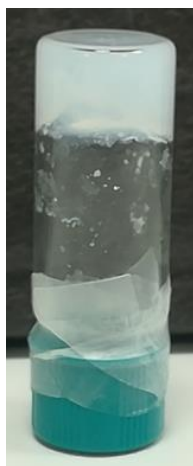
Εικόνα 57: Σταθερή υδρογέλη του Fmoc-Lys(palmitoyl)-OH c=4mg/ml σε MeOH:H 2 O 2:8
