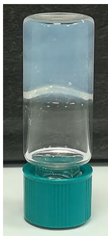
Εικόνα 59: Σταθερή υδρογέλη του Fmoc-Lys(palmitoyl)-OH c=1\text{mg/ml} σε MeOH:H 2 O 1:9
