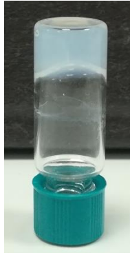
Εικόνα 63: Σταθερή υδρογέλη του Fmoc-Lys(palmitoyl)-OH c=2\text{mg/ml} σε THF:H 2 O 2:8
