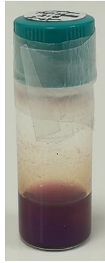
Εικόνα 73: Θολό σκούρο πορφυρό διάλυμα παρουσία ιζημάτων Fmoc-Lys(palmitoyl)-NH-TPP c=2\text{mg/ml} σε THF:MeOH 2:8
