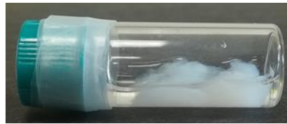
Εικόνα 32: Χαλαρή υδρογέλη του Fmoc-Lys(palmitoyl)-OH c=2\text{mg/ml} σε HFIP: \text{H}_2\text{O} 2:8
