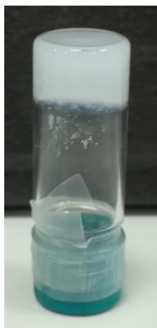
Εικόνα 61: Σταθερή υδρογέλη του Fmoc-Lys(palmitoyl)-OH c=4\text{mg/ml} σε MeOH:H 2 O 3:7
